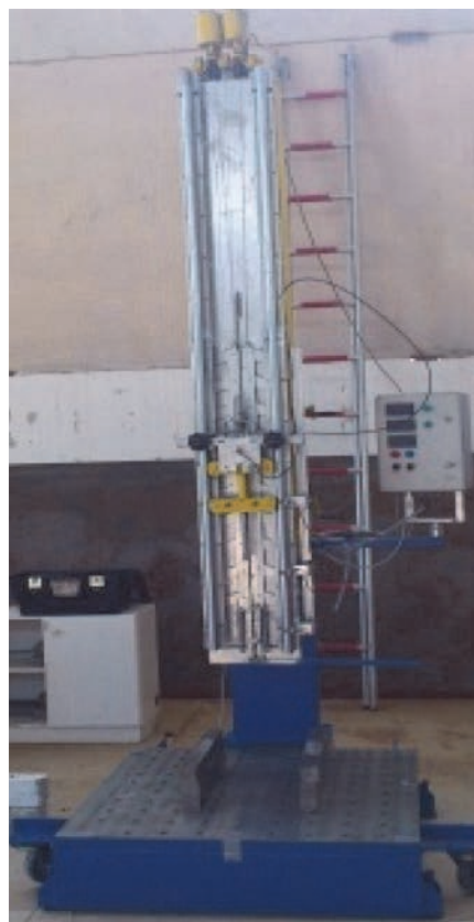
Slika 1. Uređaj za provedbu ispitivanja na udar
