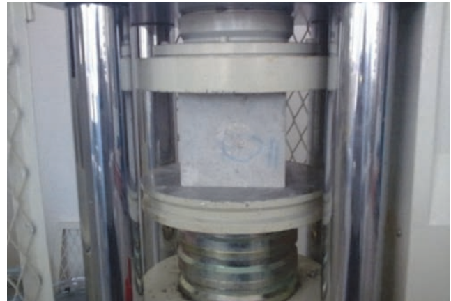
Slika 3. Ispitivanje tlačne čvrstoće betona
