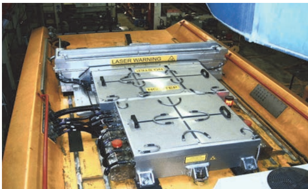
Slika 18. Sustav za mjerenje parametara stanja kontaktne mreže
