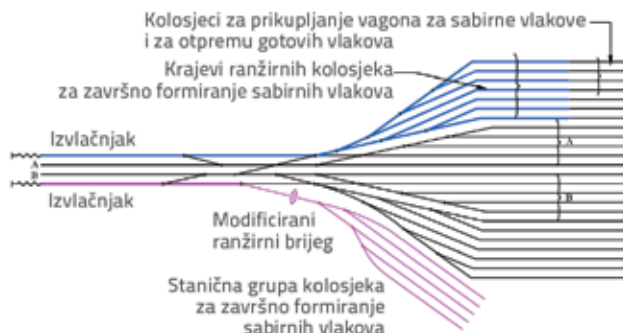
Slika 3. Postrojenja za formiranje sabirnih vlakova Futnerovom i specijalnom metodom
