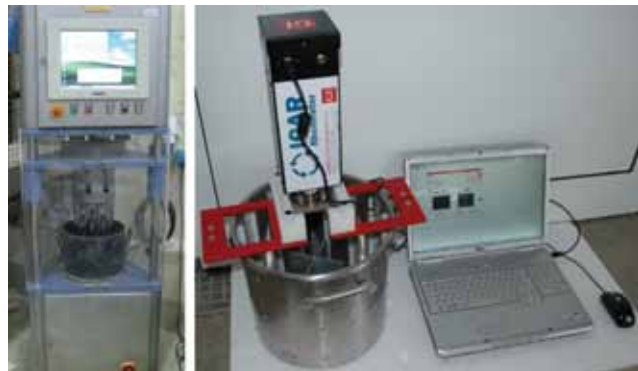
Slika 2. Reometri, ConTec Viscometer 5 (lijevo), ICAR Rheometer (desno)
