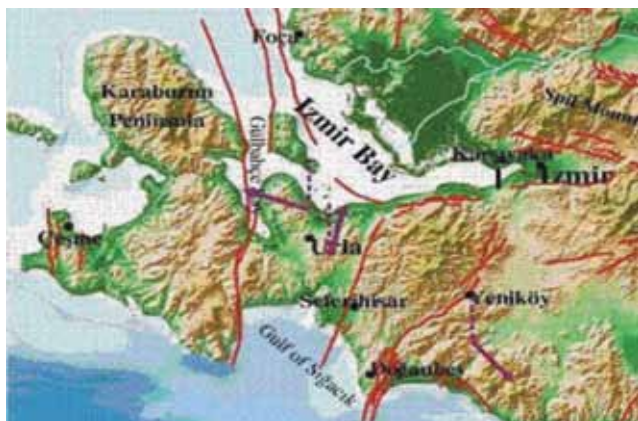
Slika 8. Prisutnost poznatih rasjeda blizu predložene trase tunela
