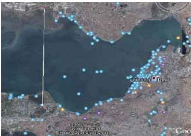
Slika 1. Trasa predloženog uronjenog tunela u Izmirskom zaljevu
