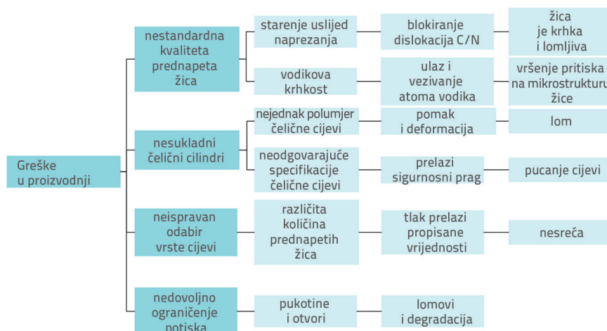
Slika 11. Greške u proizvodnji PCCP-a
