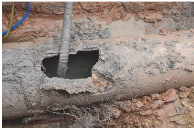
Slika 13. Dio na kojemu je došlo do oštećenja cijevi [63]
