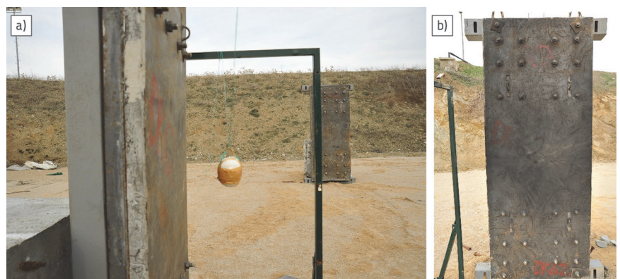
Slika 18. a) eksploziv C4 postavljen 25 cm od prednje strane ploča; b) lice ploče nakon eksplozije s vidljivim opečanim površinama, ali bez primjetnih konstrukcijskih oštećenja
