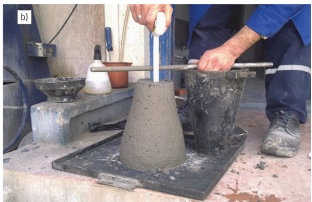
Slika 4. a) Vrijednosti tlačne čvrstoće skupa valjkastih uzoraka dobivenih iz mješavine T5; b) Ispitivanje mješavine T5 pomoću lijevka koje pokazuje slijevanje od 4 cm
