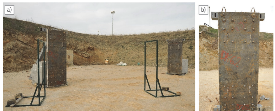
Slika 17. a) eksploziv C4 postavljen 275 cm od prednje strane ploča; b) lice ploče nakon eksplozije pokazuje manje opečenu površinu, ali nema vidljivih konstrukcijskih oštećenja
