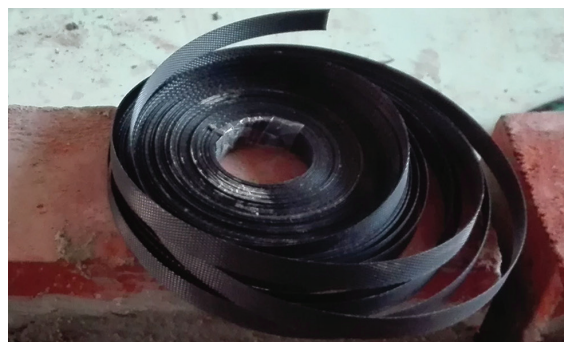
Slika 4. PP traka za pojačanje horizontalnih sljubnica
