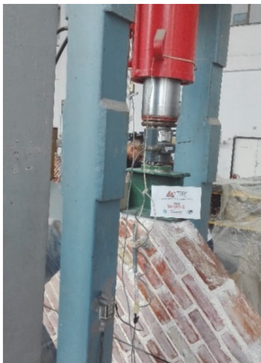
Slika 9. Ispitivanje dijagonalne vlačne čvrstoće
