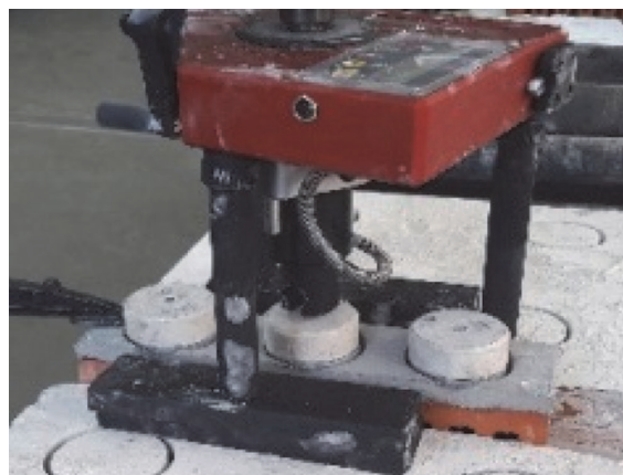
Slika 3. Ispitivanje izvlačenjem na reparaturnom mortu FS4
