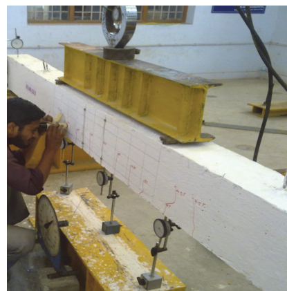
Slika 4. Mjerenje širine pukotine u tijeku
