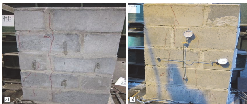
Slika 23. Oštećenja pri tlačnom ispitivanju: a) Uzorak s jednom pukotinom; b) Uzorak s dvije pukotine
