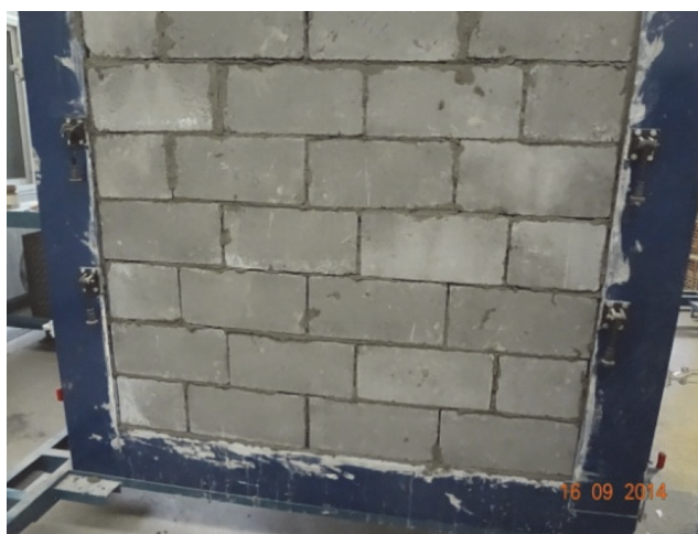
Slika 9. Pripremljeni uzorak zida za ispitivanje toplinskih svojstava
