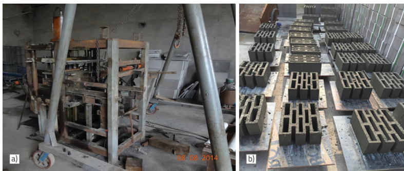
Slika 5. Proizvodnja blokova: a) Postrojenje za oblikovanje blokova pod tlakom; b) Oblikovani proizvodi - blokovi
