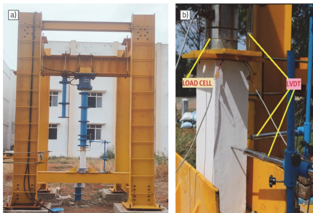
Slika 6. Eksperimentalni postav - okvir za opterećenje i raspored LVDT-a: a) Okvir za opterećenje; b) LVDT
