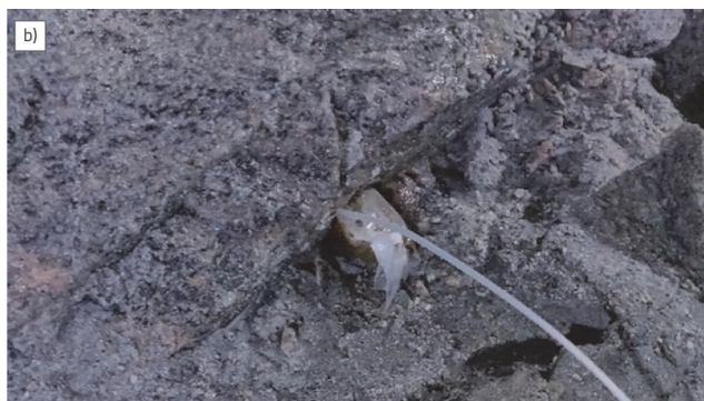
Slika 18. Vreće s vodom i primjena na terenu: b) Začepljivanje bušotina vrećom s vodom i pijeskom
