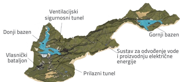
Slika 8. Sveobuhvatna shema reverzibilne hidroelektrane Tianchi u pokrajini Henan
