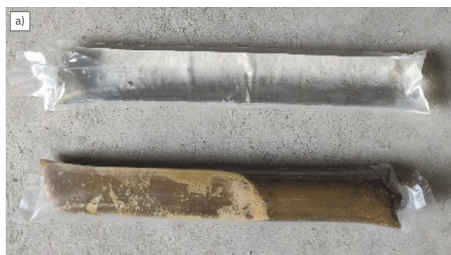
Slika 18. Vreće s vodom i primjena na terenu: a) Vreće s vodom i vreće s vodom i pijeskom
