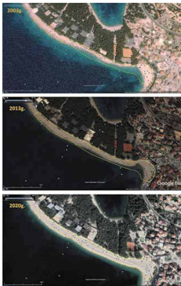
Slika 3. Uočeno nagomilavanje materijala te pomicanje obalne linije zbog dužobalnoga transporta od djelovanja garbina na plaži Mala Raduča (Primošten)
