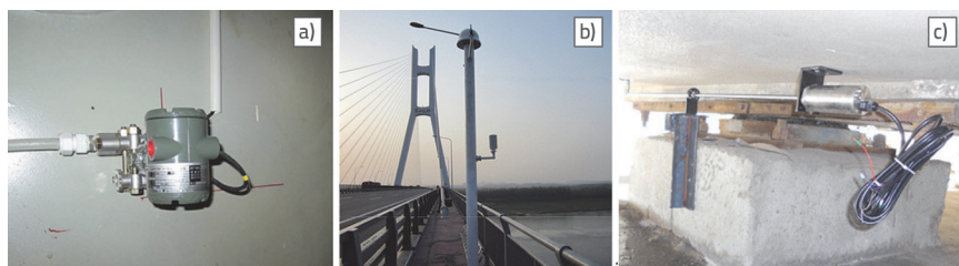
Slika 5. Prikaz mjerača progiba, magnetostriktivnog i GPS-a senzora pomaka: a) mjerač progiba; b) GPS; c) magnetostriktivni senzor pomaka
