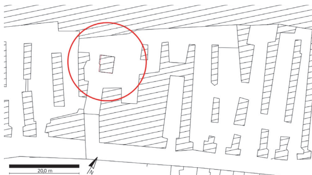
Slika 2. Nacrt podrumskog sustava s ispitanim stupom; iscrtkano se područje odnosi na potporni sustav
