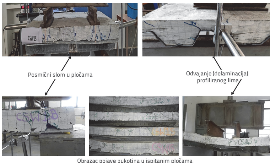
Slika 3. Obrazac pojave pukotina na spregnutoj ploči
