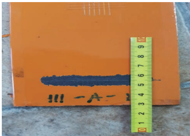
Slika 6. Određivanje stupnja delaminacije nakon slane komore
