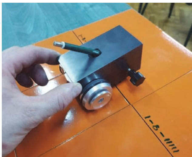
Slika 4. Mjerenje tvrdoće premaza na uzorcima
