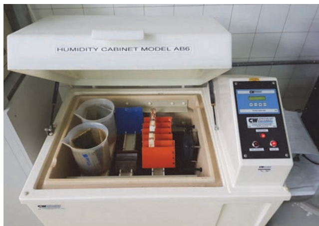
Slika 7. Ispitivanje uzoraka u vlažnoj komori
