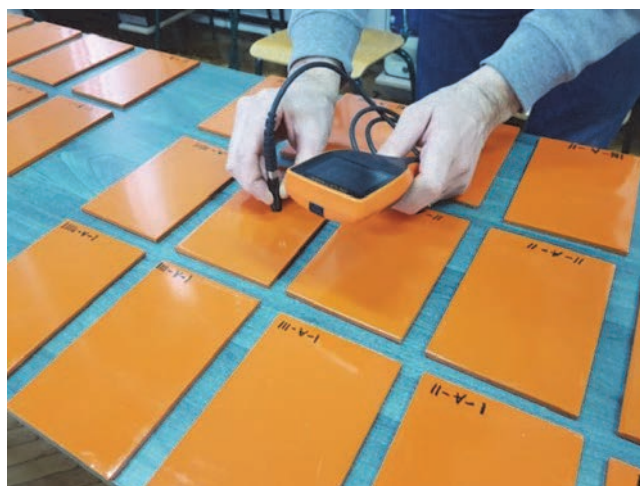
Slika 2. Mjerenje debljine premaza na uzorcima
