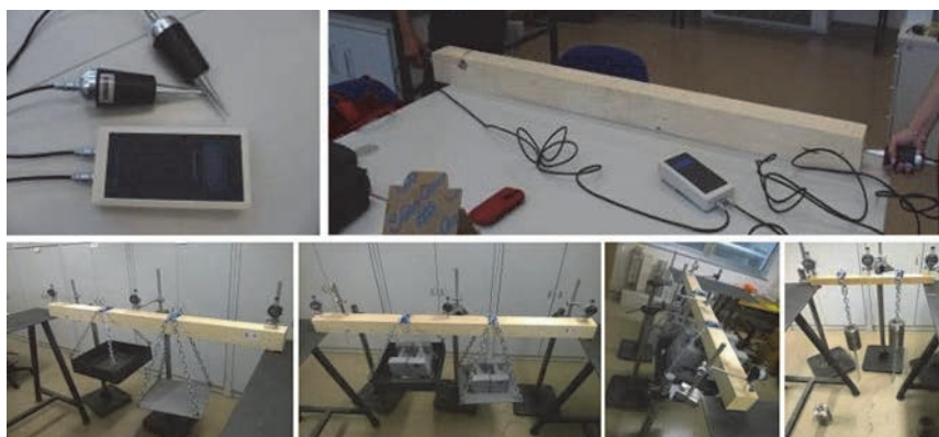
Slika 3. Oprema i provedba testova, nerazorni testovi: a) ultrazvučni test osnog valovanja (faza 2); b) statički test na savijanje (faza 3)
