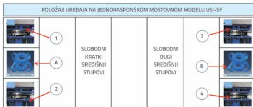
Slika 23. Položaji uređaja DRSRB (1 do 4) i uređaja SF-ED (A i B) na jednorasponskom prototipskom modelu mosta USI-SF u velikom mjerilu, prilikom ispitivanja na potresnom stolu
