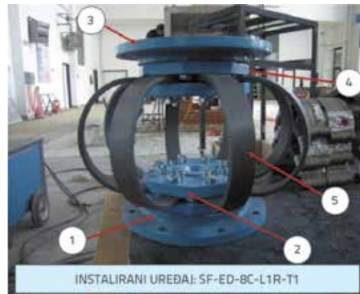
Slika 9. Instalirani osnovni uređaj SF-ED-8C-L1R-T1: (1) donja osnovna ploča; (2) donje nosive ploče; (3) gornja osnovna ploča; (4) gornje nosive ploče; (5) komponenta SF-ED
