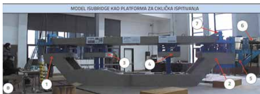
Slika 5. Model mosta USI-SF za ispitivanje uređaja DSRSB i SF-ED u uvjetima simulacije reverznog cikličnog opterećenja: 1) krajnja lijeva potpora; 2) krajnja desna potpora; 3) potpora iznad kraćih središnjih stupova; 4) potpora iznad dužih središnjih stupova; 5) potporna čelična konstrukcija hidrauličnog pokretača; 6) hidraulični pokretač za nanošenje cikličnog opterećenja; 7) potpora uređaja DL u vidu čelične konstrukcije; 8) kontrolni računalni sustav
