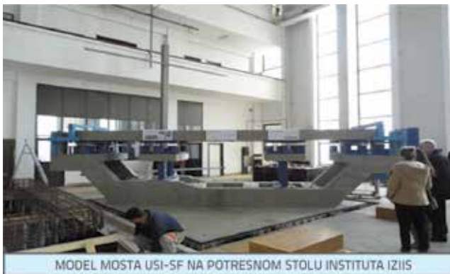
Slika 19. Prototipski model mosta USI-SF za ispitivanje seizmičkog ponašanja postavljen na IZIIS-ovom potresnom stolu, sa dva originalna uređaja SF-ED-4C-L1R-T1 i četiri uređaja DSRSB
