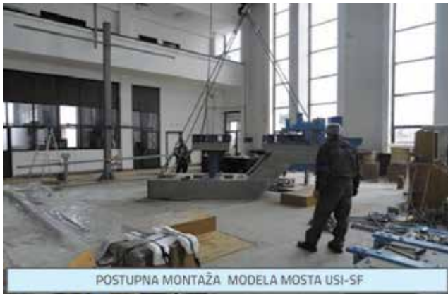
Slika 22. Laboratorijska montaža na potresni stol modela mosta USI-SF u velikom mjerilu radi provođenja seizmičkih ispitivanja simuliranjem stvarnih potresa
