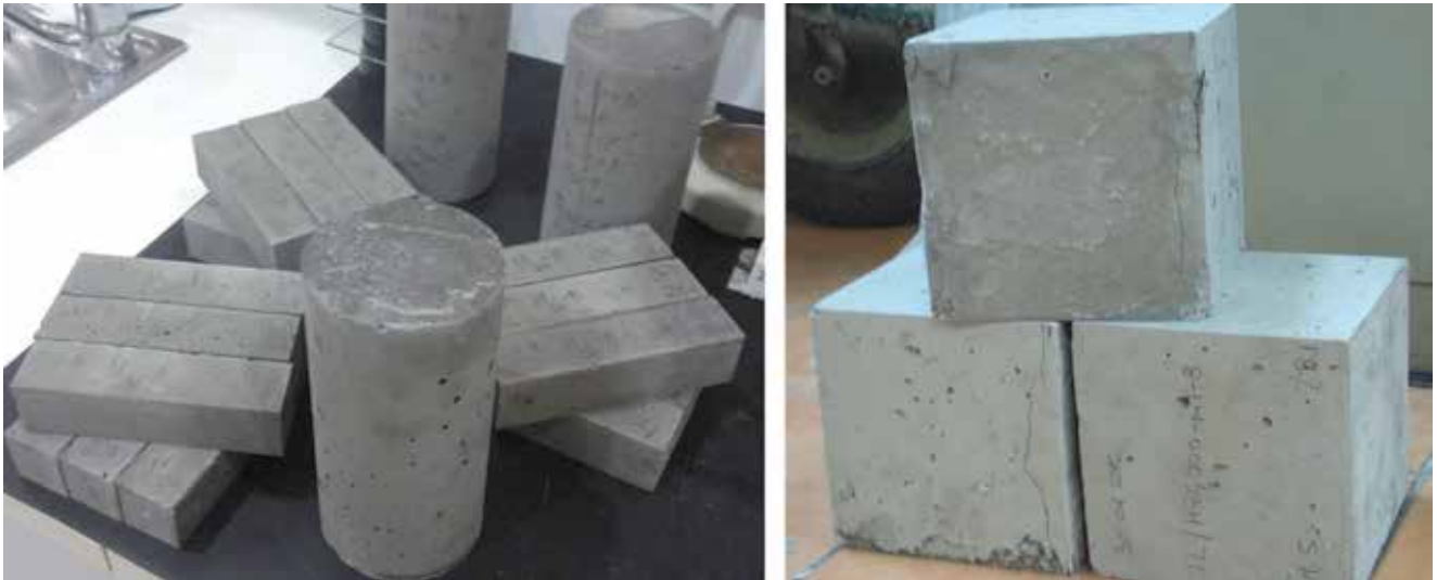
Slika 2. Uzorci jedne mješavine morta (lijevo) i betonske kocke za ispitivanje tlačne čvrstoće i maksimalne dubine prodora vode pod tlakom (desno)
