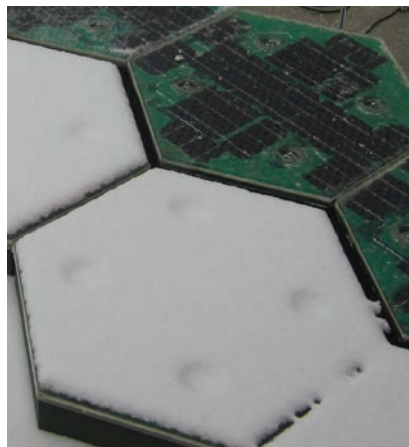
Solarni paneli i obični betonski elementi tijekom testiranja na snijeg
