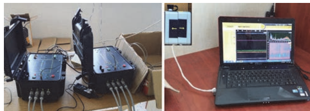
Slika 4. Jednoosni akcelerometri, uređaj za obradu signala i kontrolni uređaj
