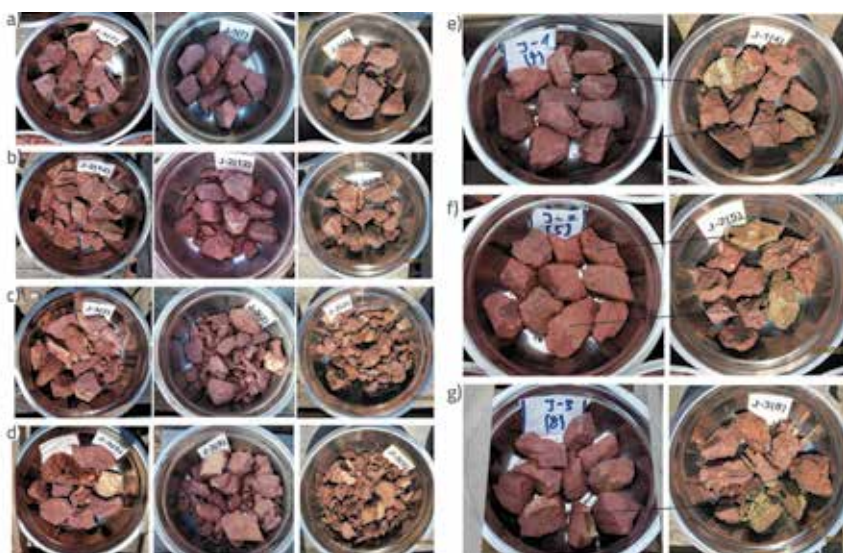
Slika 11. Uzorci 2, 5 i 12 mjeseci: a) J-1(7); b) J-2(12); c) J-3(2); d) J-3(5); i promjena površinskih stanja za uzorke e) J-1(4); f) J-2(5); g) J-3(8)
