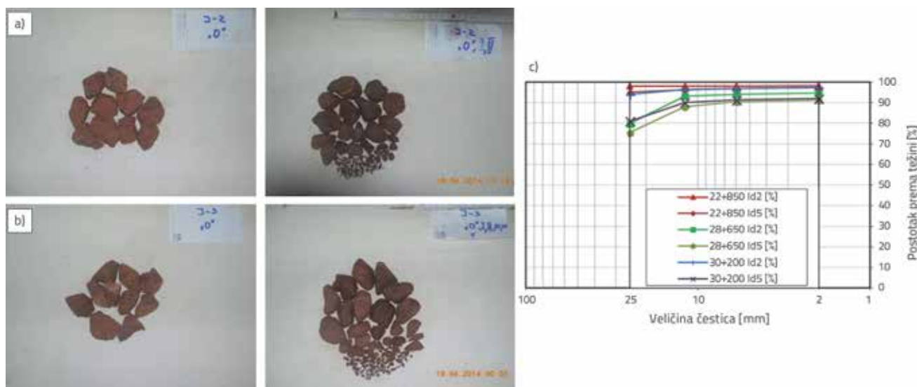
Slika 9. a) Uzorak s km 28+650 prije pokusa i nakon drugog ciklusa, b) Uzorak s km 30+200 prije pokusa i nakon petog ciklusa, c) Granulometrijske krivulje nakon drugog i petog ciklusa
