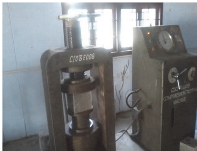
Slika 12. Ispitivanje tlačne čvrstoće na kockama nakon toplinskog tretiranja u peći
