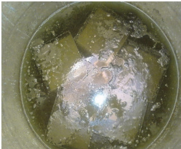
Slika 8. Ispitivanje otpornosti uzoraka kocki na kiselinu
