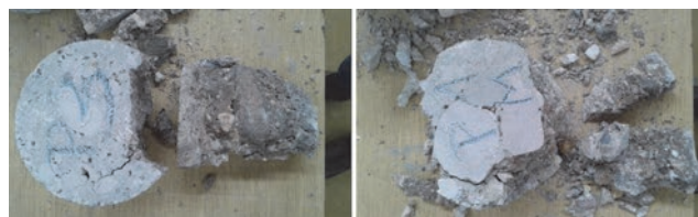
Slika 29. Izgled uzorka izvađeni iz ostalih dijelova konstrukcije
