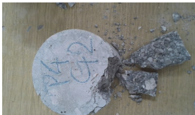
Slika 28. Izgled uzorka izvađenih iz pješačke staze (P4)
