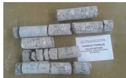
Slika 27. Izgled uzoraka betona prije obrade i ispitivanja
