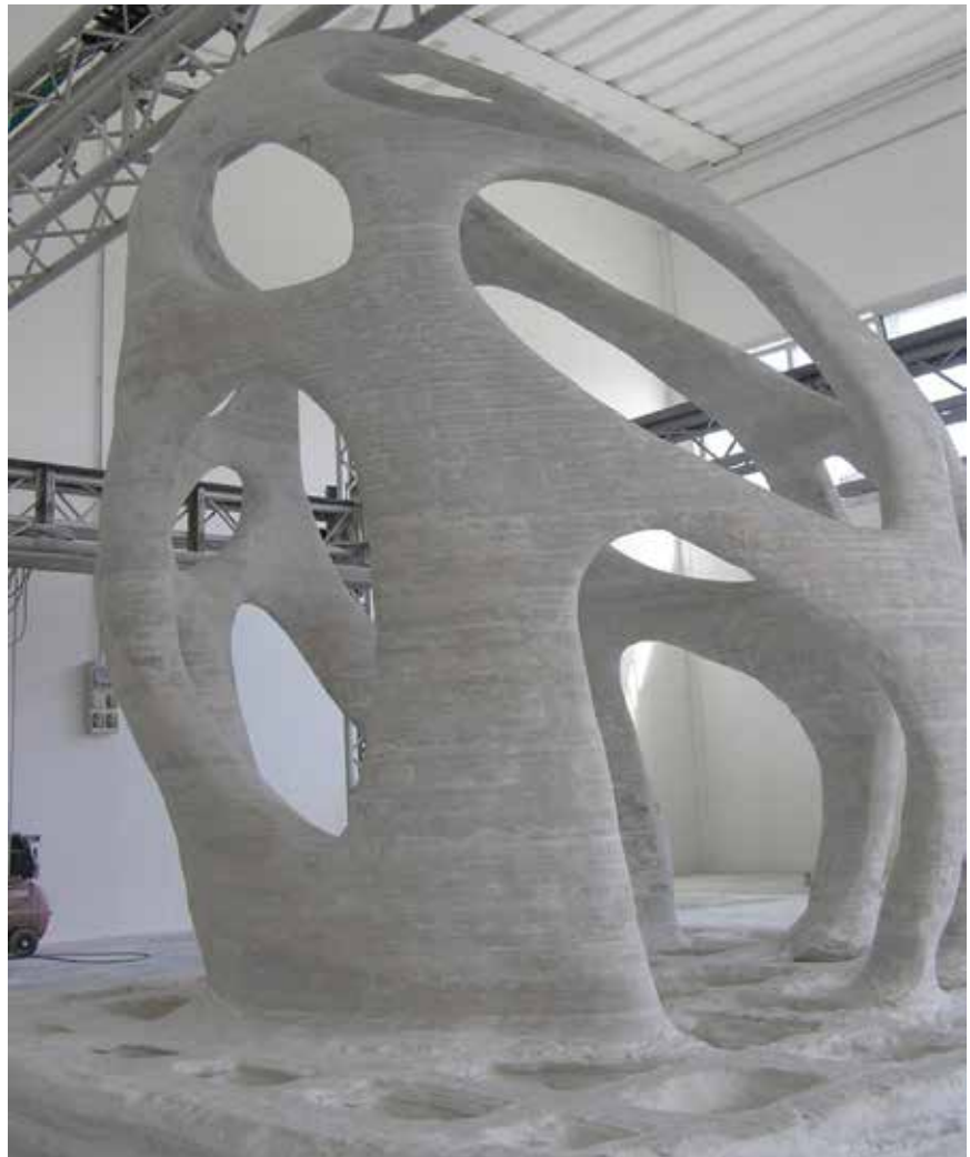
Prva primjena klasične stereolitografije u graditeljstvu - sjenica Radiolaria
