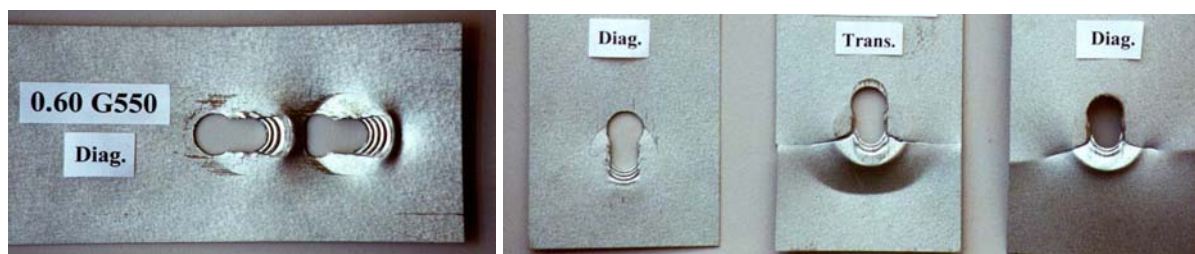
Slika 20 – Lom gnječenjem lima u zoni rupe
