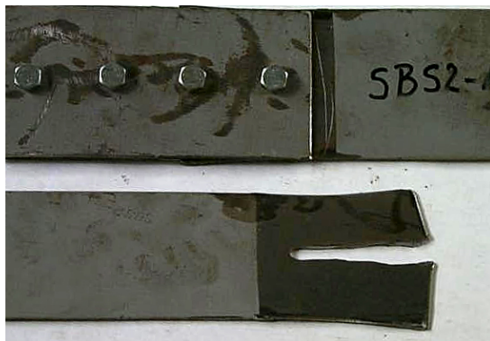
Slika 10 – Lom cepanjem lima
