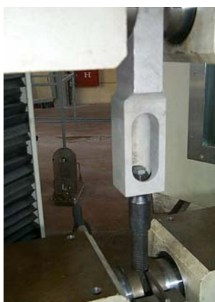
Slika 8 - Ispitivanje nosivosti običnih vijaka i F - \delta dijagrami
